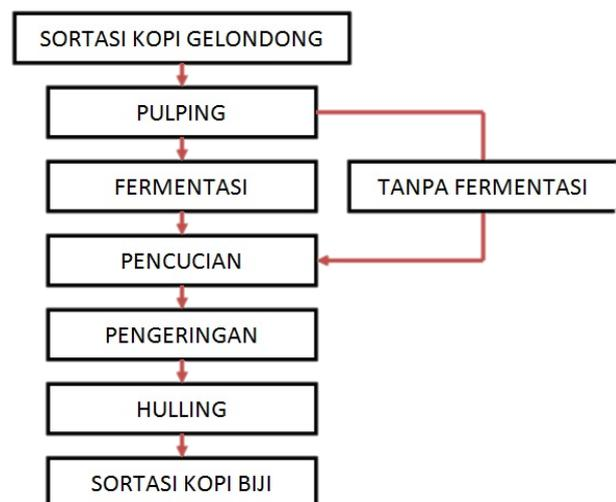
Gambar 3. Tahapan penanganan buah kopi cara basah (*fully washed*)
